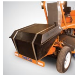
Tanque de agua de 400 l.
